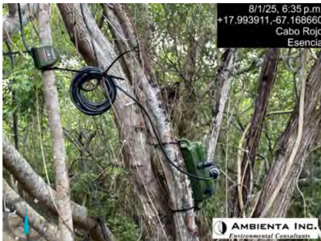
Instalación de grabadoras acústicas.
