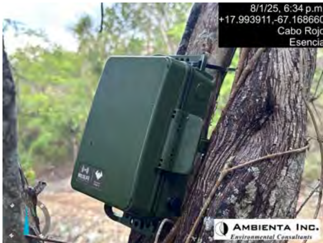
Instalación de grabadoras acústicas.
